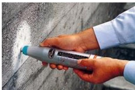
Prova sclerometrica con lo sclerometro di Schmidt
