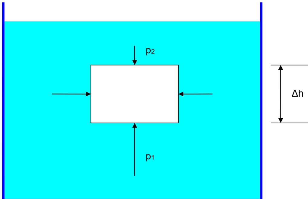
Infatti se consideriamo il volume parallelepipedo  $V$ , all'interno di una massa di fluido, sulla superficie della sua faccia inferiore di area  $S$  agirà la pressione  $p_1$ , diretta verso l'alto, che sarà pari alla pressione  $p_2$  agente sulla sua faccia superiore incrementata della pressione dovuta alla forza peso della massa di fluido, pari a  $\rho \cdot V$ , contenuta nel volume  $V$ :
